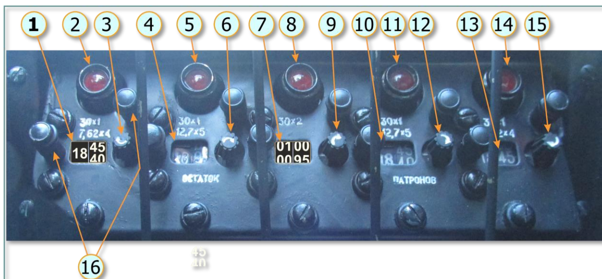
Fig. 4.11. Counter of cartridges USB-1-2A
